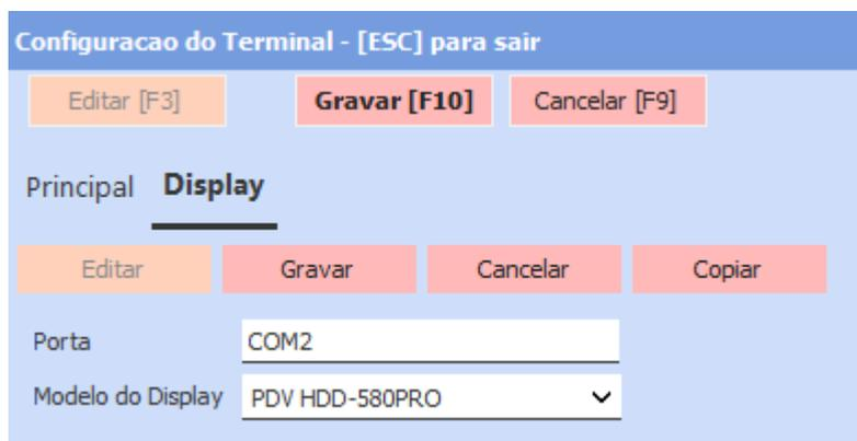
Após realizada a configuração, será necessário encerrar o sistema e reiniciar o equipamento para que a comunicação com o display seja efetuada.
