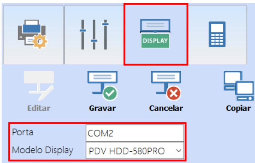
Após realizada a configuração, também será necessário encerrar o sistema e reiniciar o equipamento para que a comunicação com o display seja efetuada.
